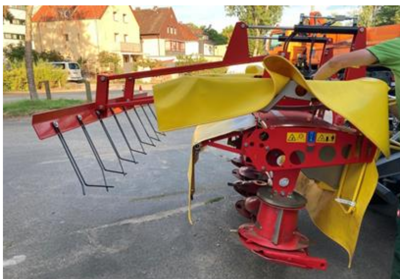
Abbildung 3: Kreiselmäher mit Scheuchvorrichtung. Foto: Grünflächenamt Wissenschaftsstadt Darmstadt.
