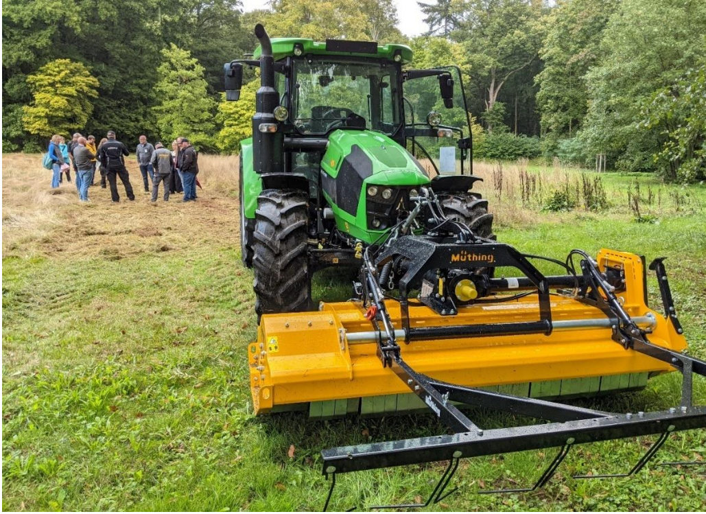
Abbildung 17: Mucher mit Insektenscheuche von Müthing GmbH & Co. KG. Foto: Niko Martin
