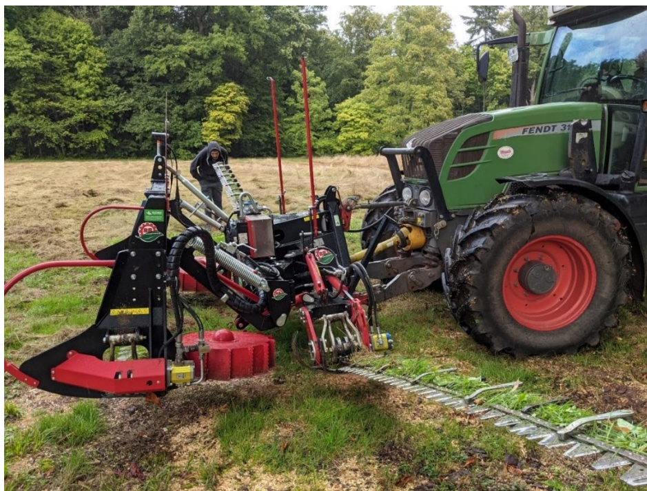
Abbildung 19: Frontschmetterlingsmäherwerk BB-Umwelttechnik GmbH. Foto: Niko Martin
